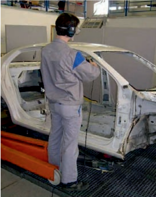
Bild A7.7: Erhöhte elektrische Gefährdung durch leitfähige Standfläche (hier: metallene Gitterroste)
