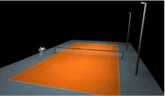
Die zum Einsatz kommende Technologie ermöglicht die Beleuchtung eines Tennisplatzes mit zwei Leuchten à 450W. Die Gesamtleistungsaufnahme ist mit 900W je Tennisplatz damit wesentlich geringer als die von konventionellen Leuchtmitteln. Hierdurch lassen sich hohe Energieeinsparungen erzielen, womit sich die Modernisierung schnell rechnet.
