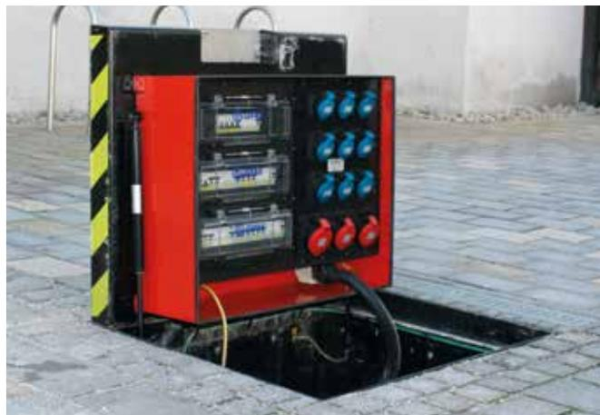
Massive Edelstahlkonstruktion (V2A/1.4301), Gasdruckfedern zum vollautomatischen Öffnen, Schachtdeckel individuell befüllbar, Verteiler nach Kundenwunsch.
