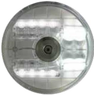
Die MarkLED EXIT vereint zwei Beleuchtungssysteme einer Tunnel-Betriebssicherheitsausrüstung. Sie bildet die Kombination aus Markierungs- und Fluchtwegleuchte. Die Markierungsleuchten (optische Leiteinrichtung) werden in der Regel mit Abständen von 12,5m bzw. 25m installiert. Die Fluchtwegleuchten sind in einem Abstand von 50m montiert. Die MarkLED EXIT ist deshalb mit zwei separaten Leuchtbereichen mit den beiden unterschiedlichen Charakteristiken ausgestattet.
