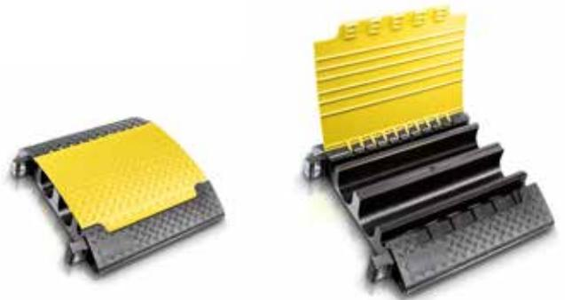
Die MEGA wurde für Großveranstaltungen entwickelt. Hauptmerkmal dieser Schwerlastbrücke sind die beiden überdimensionalen Kabel- / Schlauchkanäle für Leitungen bis zu 120 mm (z.B. 2 x A-Schlauch), bruchempfindliche Kupplungen bzw. Steckergehäuse nicht >= 100mm. Für den Einsatz im öffentlichen Straßenverkehr beachten Sie bitte Ihre länderspezifische Straßenverkehrsordnung.
