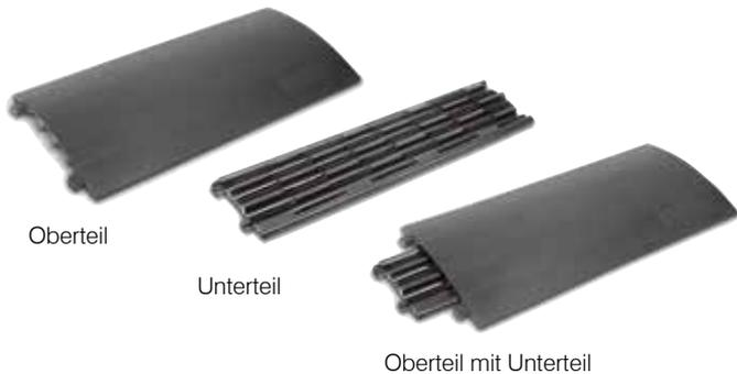
**MINI Oberteil** - Die preisgünstige Variante der GIFAS Kabelbrücken. In den Boden geformte Noppenreihen ermöglichen eine Vielzahl von Kabeln unter die MINI zu legen und damit das Gewicht von Fußgängern und Fahrrädern zu tragen. Nicht für den Straßenverkehr geeignet! Angespritzte Verbinderspindeln ermöglichen ein schnelles Verbinden und die Spindeln können nicht mehr verloren gehen.
