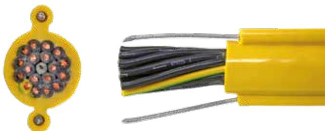
Die GIFAS KRANFLEX ist eine Spezialmischung aus kälteflexiblem, witterungsbeständigem PVC als Mantel- und Adermaterial. Die auftretenden Zugkräfte werden durch zwei gegenüberliegende und achsparallel angeordnete, mit dem Außenmantel verbundene Stahlseilragelemente aufgenommen.
