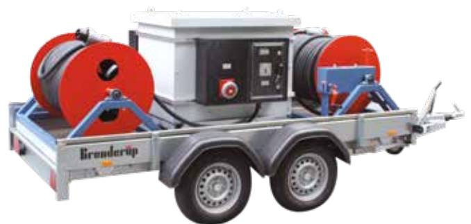
Revisionswagen „3 in 1“-Transformator, Großleitungsroller, Anhänger Drehstromtransformator
