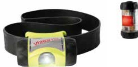
Die Vizion I ist eine echte Industriekopflampe. Sie leitet den hellen, zentrierten Strahl dorthin, wo man ihn braucht. 3 Strahlformen (Spot, Streulicht u. rotes Streulicht) sind ebenso wählbar wie zwei Leistungsstufen. Zudem kann das LED Lampenmodul aus der Lampe herausgenommen und als Notlicht/ Arbeitslicht verwendet werden. Diese Lampe ist bemerkenswert leicht, wasserdicht und äußerst robust. Egal ob bei Minustemperaturen oder aber in nasser Umgebung, sie kann überall eingesetzt werden.
