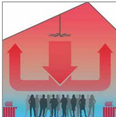
Temperaturverteilung mit Deckenlüfter
