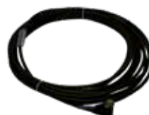
Anschlusskabel 5m schwarz, mit Dose abgewinkelt 3P, IP67, 3x0,25mm² Art.-Nr. 268321
